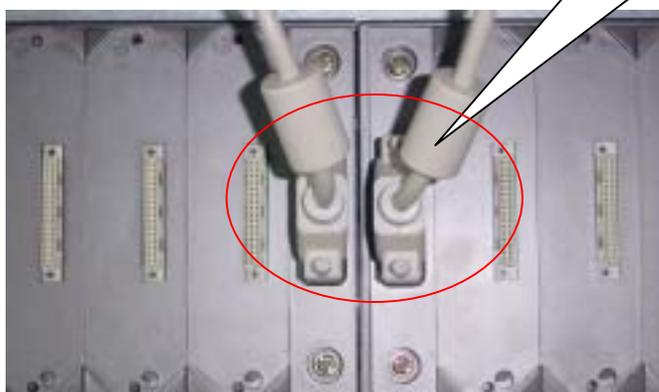
当 I/O 点数较多时，可以扩展 I/O 底板模块，底板模块之间用总线连接线进行连接，如上图所示。
