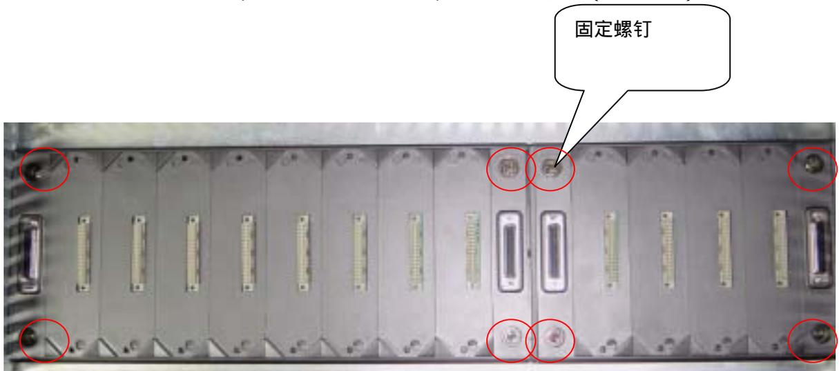
步骤一：在固定平面上准备安装孔，使安装孔的位置和尺寸与底板的定位孔一致。
