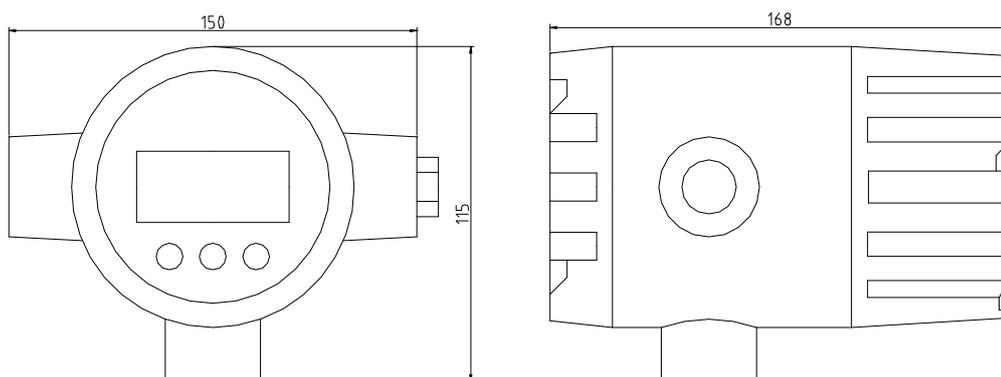
图 4-4 LRT-II、LRT-III型现场显示表外形尺寸
