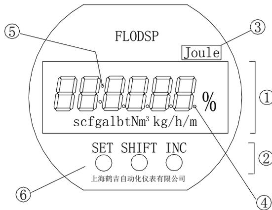
图 6.2 LRT-I、LRT-II 型现场流量积算表显示器
