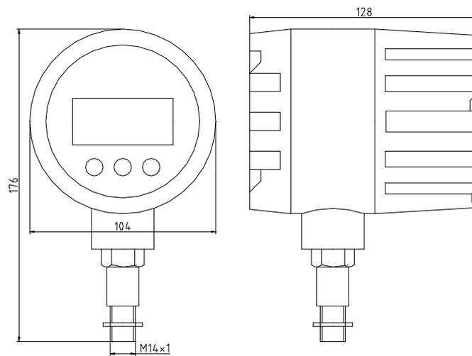
图 4-3 LRT-I 型现场显示表外形尺寸
