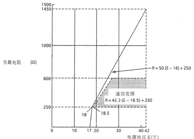
图 5-3 电源电压与负载 (4~20mA DC 输出) 的关系
