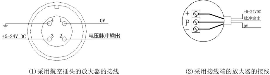
图 5-1 普通脉冲输出放大器接线
