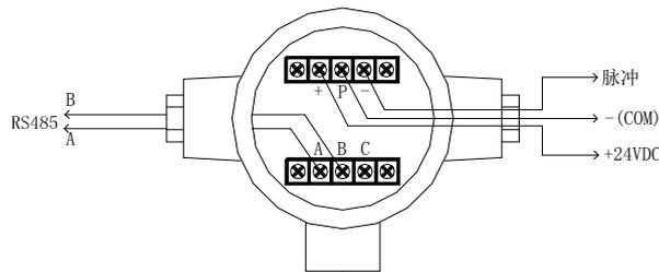
图 5-5 LRT-III现场显示表三线制脉冲输出接线
