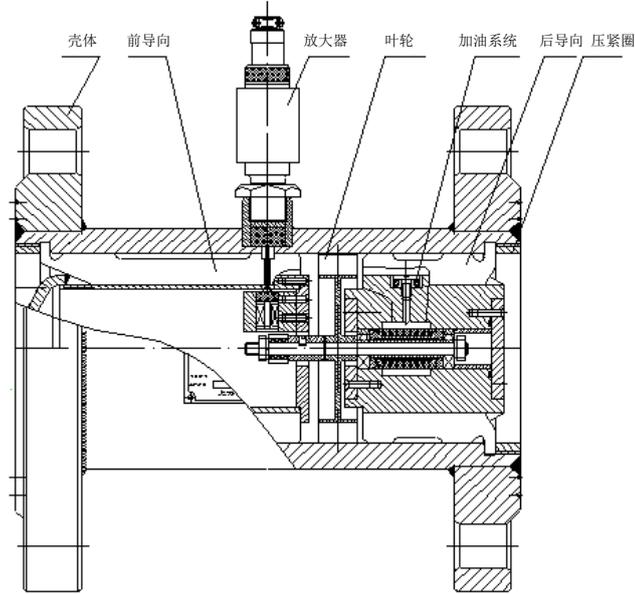
图 3-1 LWGQ 气体涡轮流量传感器结构图
