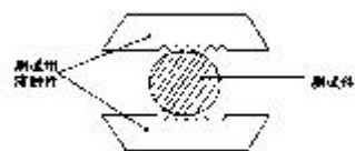
图6 测试钳与测试件的正确接法
