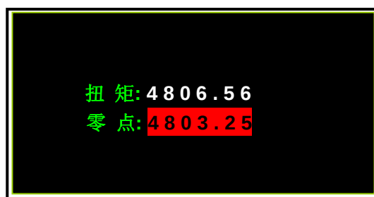
图 2-9 单零点调零界面
