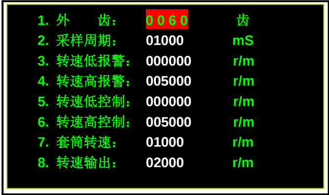
图 2-8 转速参数设置界面
