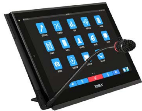
图 1.1.2 HCS-8368/50 系列第三代无纸化多媒体会议终端
