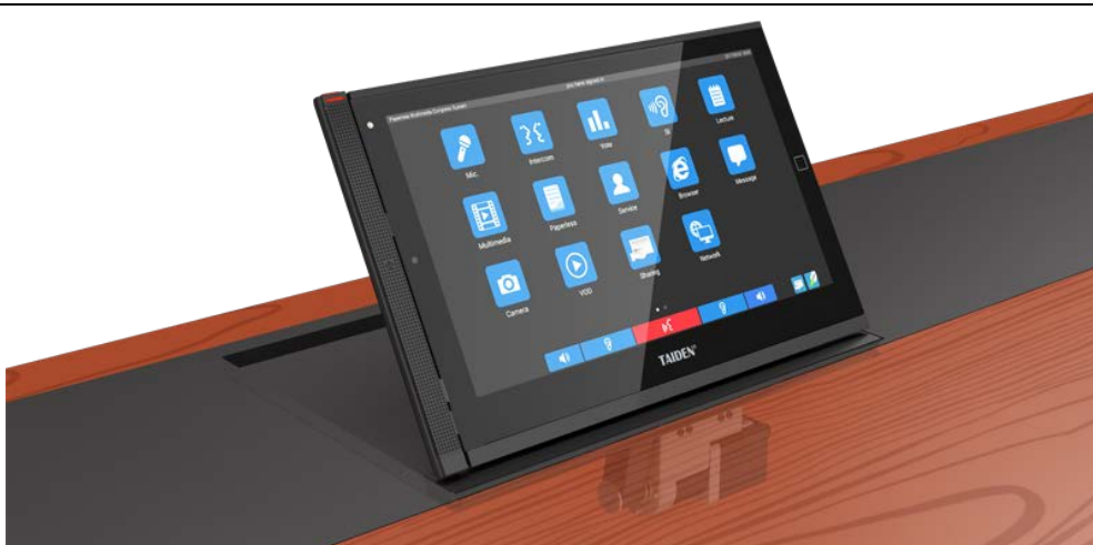
所有机器固定好下边缘后，系统通电，然后通过控制软件或主机操作菜单将单元升起
