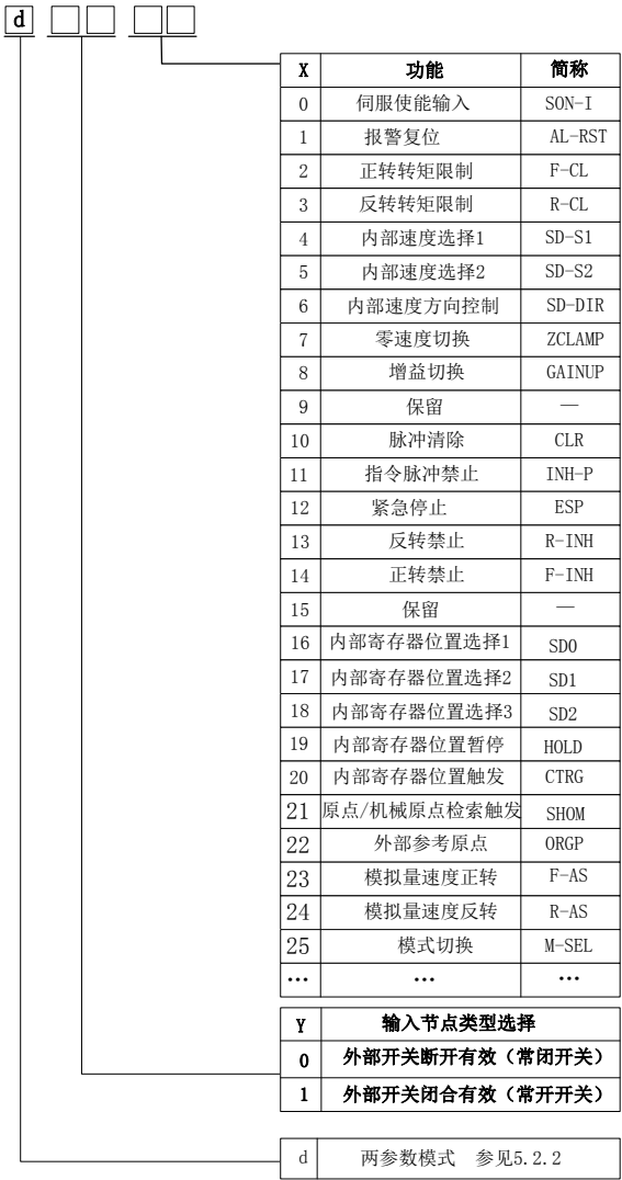
图 8.1.1 可编程输入端子功能设定示意图
