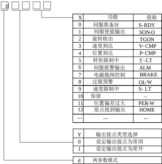
图 8.1.2 可编程输出端子功能设定示意图
