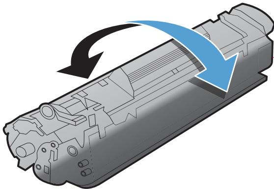
5. 弯曲碳粉盒左侧的卡扣，直至卡扣松开，向外拉卡扣，直到将整条胶带从碳粉盒中拉出。将卡扣和胶带放在打印碳粉盒包装盒中，以便回收利用。
