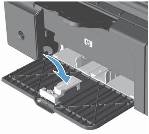
3. 将纸张插入产品，然后调整侧面的介质导板，使其紧贴纸张。
