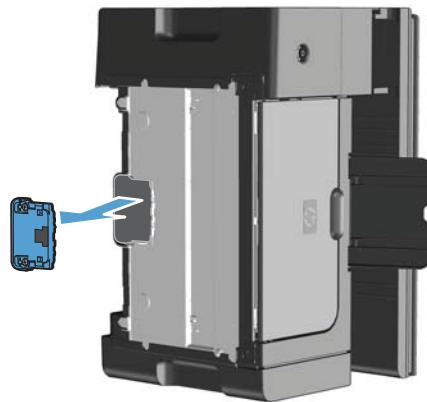
5. 用沾有异丙醇的无绒软布擦洗分隔垫。使用干的无绒软布擦去浮灰，等待分隔垫晾干。
