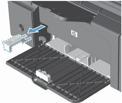
2. 将该工具连接到前介质导板。
