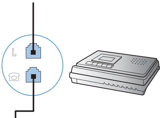
7. 要连接电话，请将电话线插入前一设备的“电话”端口。将电话线的另一端插入电话的“线路”端口。
