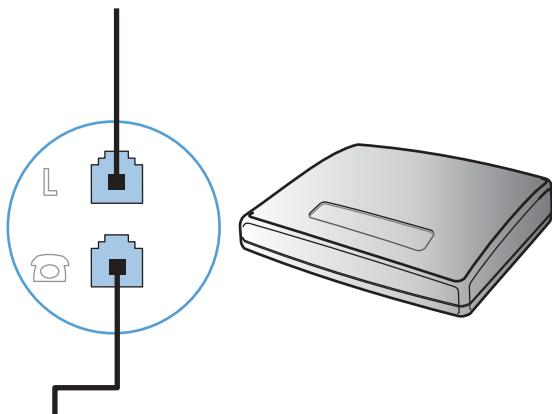
6. 要连接应答机，请将电话线插入前一设备的“电话”端口。将电话线的另一端插入应答机的“线路”端口。
