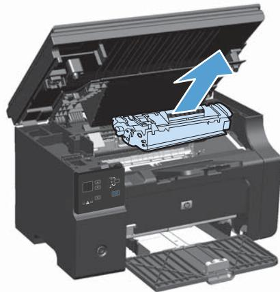
3. 在打印碳粉盒挡盖打开的情况下，用两手抓住露出最多的卡住介质一边（包括介质中部），小心地将其从产品中拉出。
