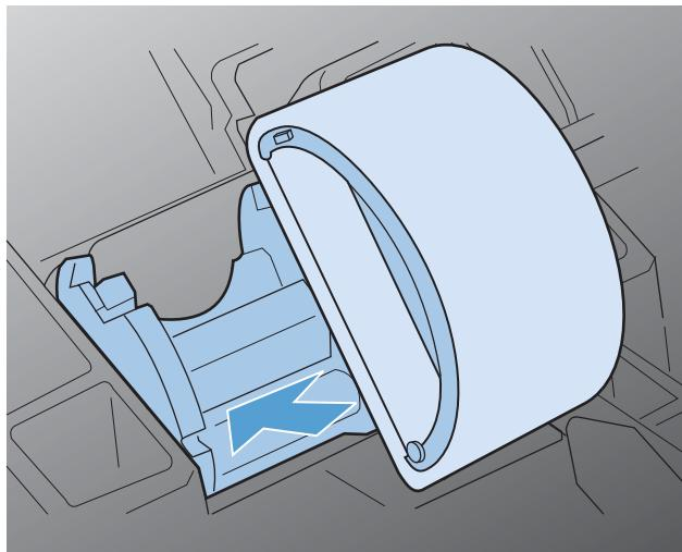
7. 将新的取纸滚筒的顶部向远离您的方向旋转，直到两侧均卡入到位。
