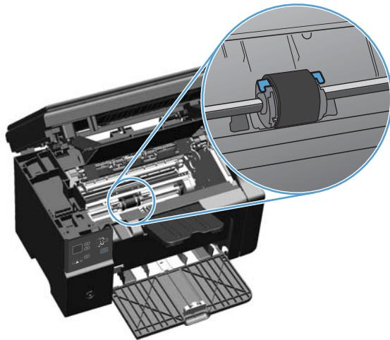
4. 松开取纸滚筒两侧的白色小压片，将取纸滚筒向前方旋转。
