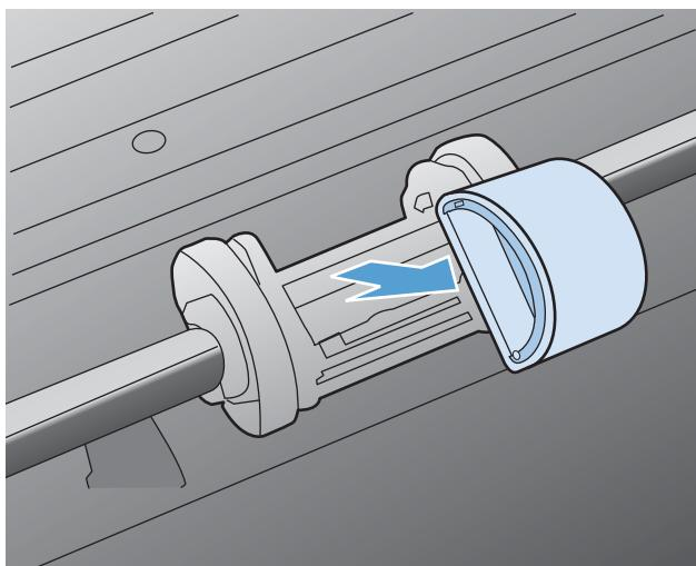
6. 将新的取纸滚筒放入纸槽。每一侧的圆形和矩形槽口会阻止您正确安装取纸滚筒。
