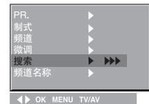
或按▲/▼键选择频道,根据需要按▶键再按▲/▼键选择V/UHF或有线,请直接使用数字键来选择频道号码,输入小于10的号码时,要在号码前加“0”。例如:5是“05”。然后按OK(确定)键。如果接收的信号弱,请参照下页的微调功能来调整。
