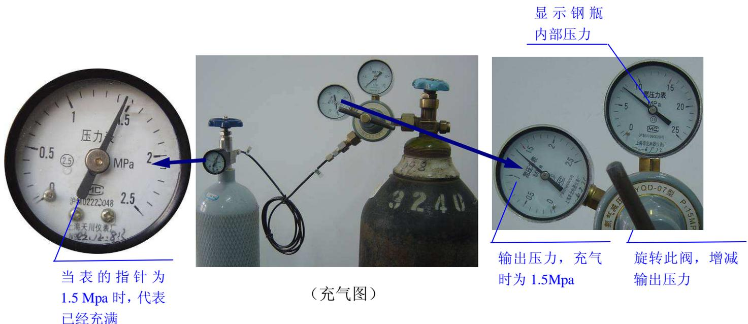
6.13 现场校验 SF6 密度继电器时，先将继电器的控制电源断开，再连接测试电缆。(如果密度继电器与本体之间没有阀门，则需要把密度继电器拆下再校验)
