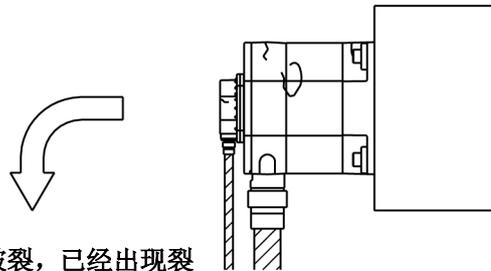
**若脉冲编码器盖板破裂，已经出现裂痕，应立即更换脉冲编码器！**
