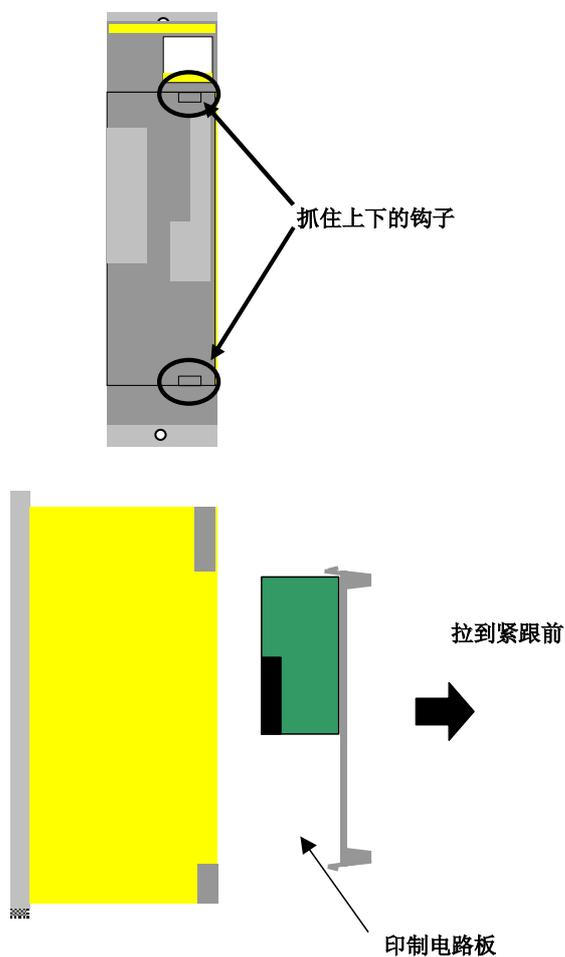
插入印制电路板的时候顺序相反。
