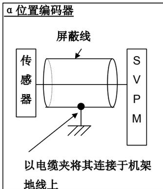
(3) 电机旋转时发生报警的情形
