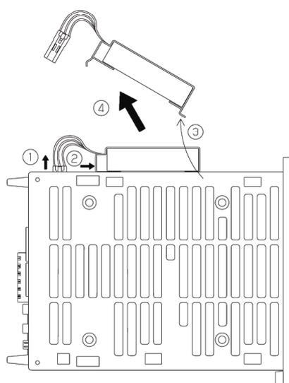
更换风扇电机时，注意电机的朝向和电缆拉引位置
