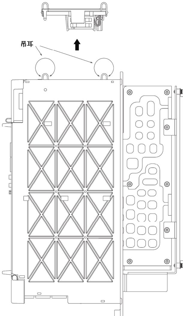
更换风扇电机时，注意电机主体和连接器的朝向
