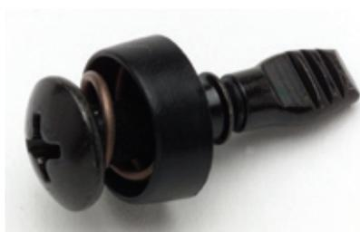
一推螺栓，弹射装置便锁入搭扣。自动弹出弹簧产生锁紧力，可容许更厚的材料。1/4 转即可打开弹射装置。自动弹出螺栓组件在面板和支撑物之间有较窄的空间，可与方孔或侧向容许搭扣一并使用。
