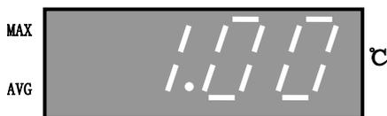
图 14 发射率/坡度显示
