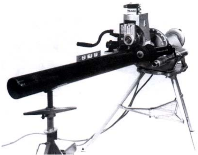
图 11—用管架和 918 来调整水平管子
