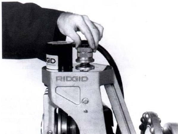
图 14—关闭带刻度的深度调节旋钮，退到直至靠在顶部铸件上
