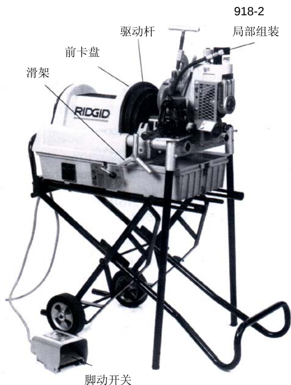
图 4 将 918-4 重型开槽机安装在 1224 套丝机上
