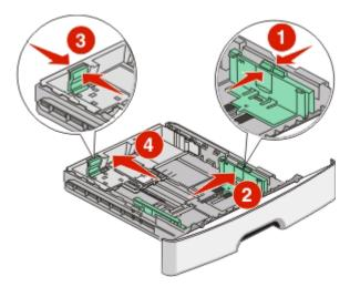
如果您加载较长的纸张尺寸,如 A4 或 legal,请压住长度导片凸柱,然后将长度导片向后滑动到与您加载的纸张长度相符的位置上。进纸匣向后延伸。
