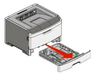
当正在打印作业或打印机控制面板上出现"忙"指示灯序列时,不要取出进纸匣。否则可能造成卡纸。
