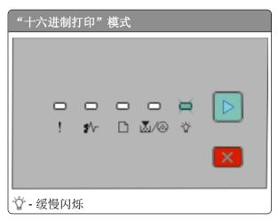
确认打印机没有处于"十六进制打印"模式。如果出现"十六进制打印模式"指示灯序列,您必须在打印作业之前退出"十六进制打印"模式。关闭打印机电源,然后再打开以退出"十六进制打印"模式。
