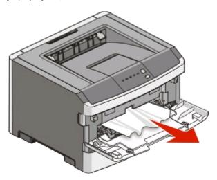
被卡在手动进纸器中的纸张通常能被抓住并直接拉出。如果不能这样取出卡纸,请检查纸张是否被卡在感光鼓组件和碳粉盒部件的后面。如需更多信息,请参阅第 107 页"清除感光鼓组件和碳粉盒后面的卡纸"。
