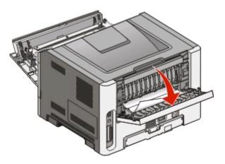
纸张的一端可能被卡在标准输出接纸架中。
