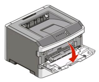
2 当 指示灯变亮时,将纸张打印面朝上放在手动进纸器的中央。
