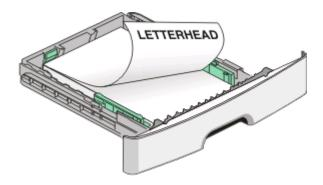
6 压住右导片上的宽度导片凸柱,然后滑动宽度导片,使它们轻轻地接触到纸堆。
