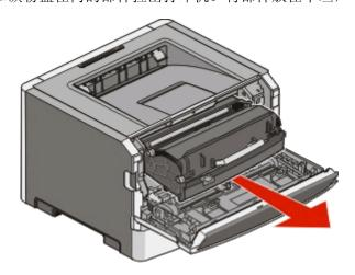
**警告—可能的损坏:**请勿触摸感光鼓组件底部的光电导体。无论何时您拿取碳粉盒,都请使用碳粉盒手柄。
