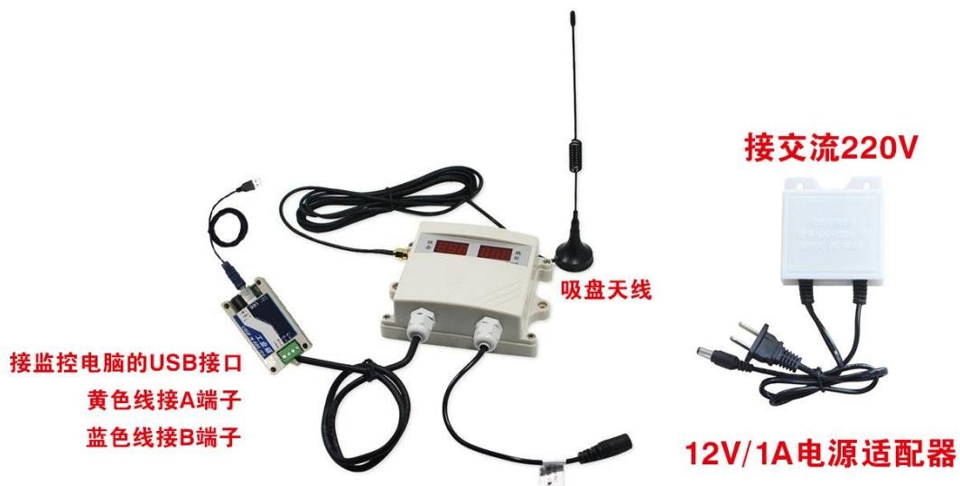
产品安装时首先将我司提供的天线拧到设备上，然后将设备安装到合适的位置上，将黄蓝两芯线与 USB 转 485 模块的 A 和 B 分别连接，将 USB 转 485 模块插入电脑，将电源适配器接交流 220V，然后将电源适配器的插头插入设备的电源插孔中。
