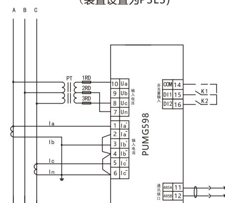
角型系统：2个电压互感器（PT）、2个电流互感器（CT）
