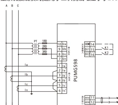
角型系统：2个电压互感器（PT）、3个电流互感器（CT）
