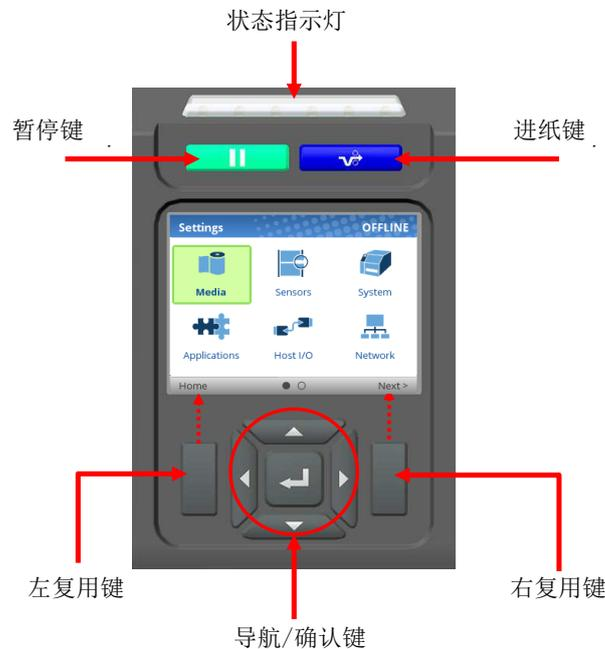
QVGA（VGA的四分之一尺寸）屏幕为320x240像素彩色显示器（非触屏）。它由一个页眉组成，页眉显示打印机的状态及用户界面（UI）的位置，一般显示区域；还包括一个页脚，用来显示左右复用键（可用时）的用途。
