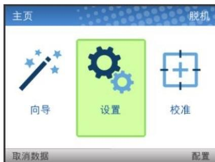
左右复用键的功能如下：如果缓冲区有数据信息且启用 *打印机设置>控制>取消操作* 时，设置左复用键“取消数据”功能。右复用键指示的“配置”将显示在用户界面上的当前配置文本，且如需要，用户可滚动浏览数据和/或打印。
