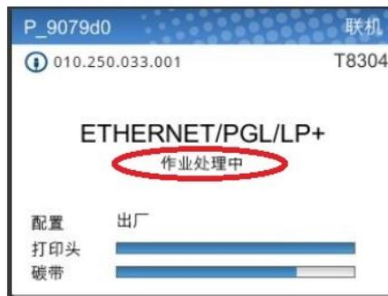
打印机处于联机模式、正在接收和处理数据时,信息区将显示“作业处理中”信息。打印完成后,信息将会消失。如果用户以批处理方式打印且启用选项 *打印机设置>控制>批处理计数器* 时,相比“作业处理中”信息,优先采用标签计数。
