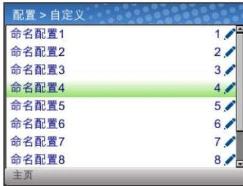
选择将命名的配置时，将为用户提供一个虚拟键盘来输入期望的名称。可使用导航键来寻找字符，输入键可以用来选择它们。当完成字符串时，用户应使用标有“应用”的右复用键。
