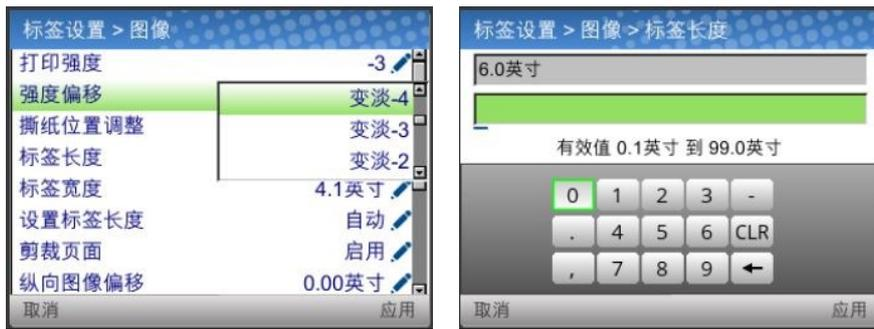
用户处在编辑模式时，通过按下输入键，或使用右复用键进入“应用”来改为新值。同样地，用户可在不更改菜单的情况下通过左复用键退出编辑模式以“取消”操作。
