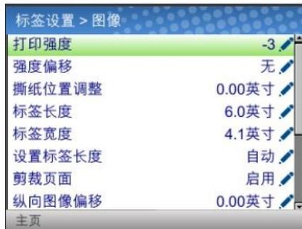
处于编辑等级时，用户可使用上下方向键滚动菜单及它们的值。通过按确认键、更改数值、并使用“应用”复用键确认改变数值可编辑带有
