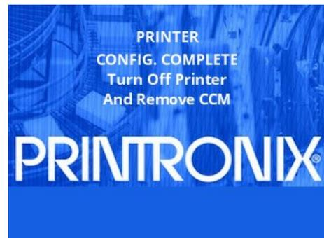
**注意：**打印机可能在配置过程中重置，这是正常的。请勿中断打印机，直到显示如上消息。
