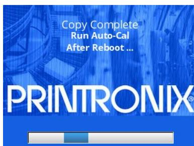
**重要：**当拷贝完成且打印机重启时，为了确保配置变更用于校准处理中，用户应允许自动校准。
