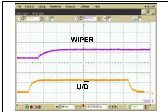
图 2-16: 2.1\text{ k}\Omega ——低电压状态下，滑动电阻递增时，滑动端电压的稳定时间 ( V_{DD} = 2.7\text{V} )
