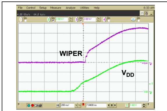
图 2-52: 50\text{ k}\Omega ——上电时，滑动端的响应时间
