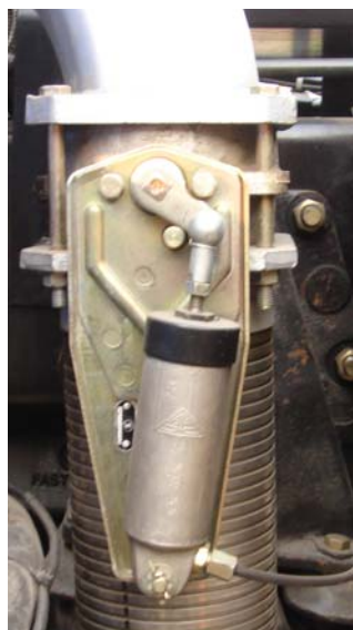
图 5-1 排气制动在整车上的安装
