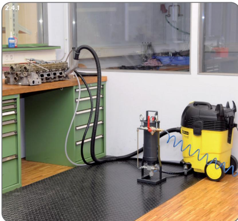
**Fig. 2.4.1** La superficie de emplazamiento debe ser plana, resistente y es le de acuerdo con el peso del aparato.
