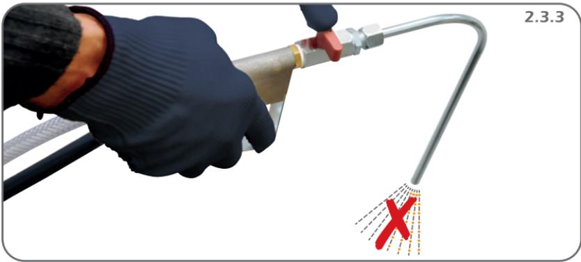
En el mango de la lanza de proyección hay una llave de paso de 2 vías. Esta puede accionarse en caso de fallo de una función de control. Cuando la llave de paso está cerrada, no puede salir aire ni producto proyectado de la lanza.
