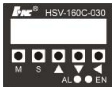
图 6.1 HSV-160C-010/020/030/50/075A 伺服驱动器面板图
