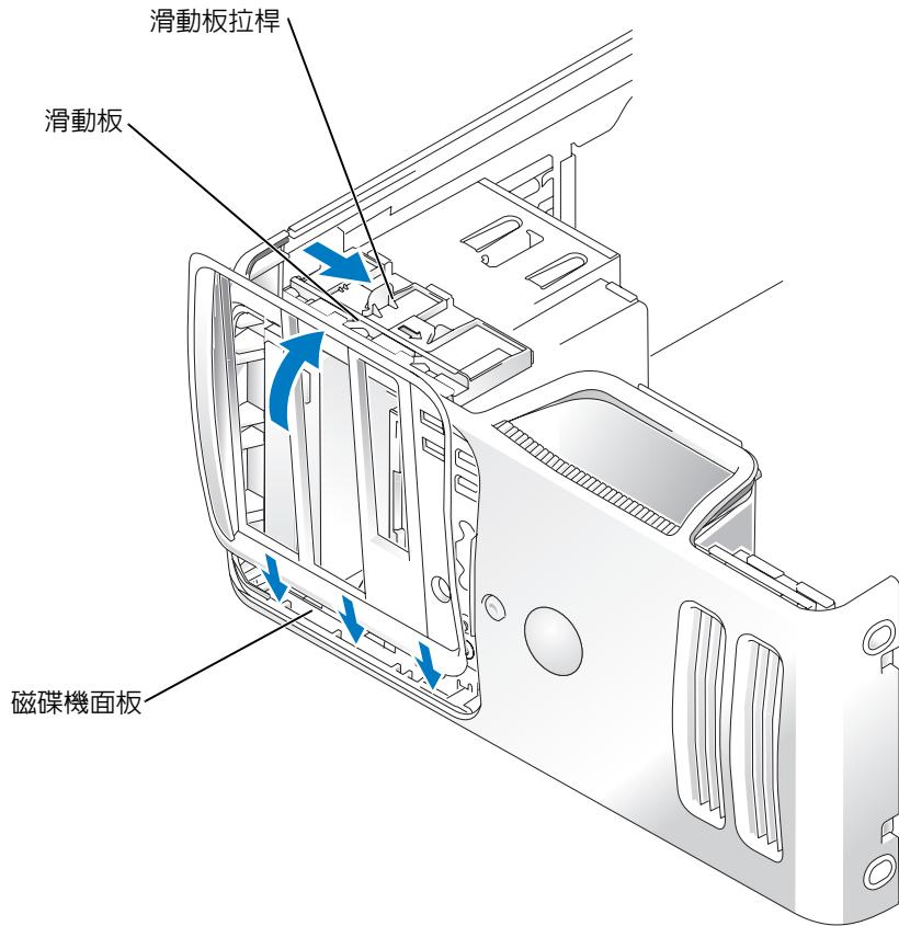
2 握住滑動板拉桿並將其推向電腦底座，直至打開磁碟機面板。
