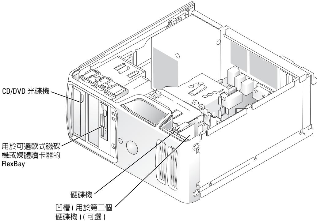
將 CD/DVD 光碟機連接到主機板上標有「IDE」的連接器上。序列 ATA 硬碟機應連接到主機板上標有「SATA0」或「SATA1」的連接器上。
