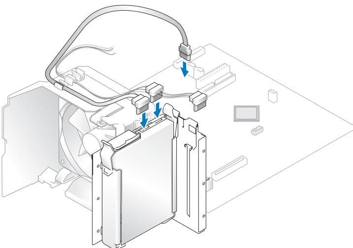
5 檢查所有連接器，確定連線正確且穩固到位。
