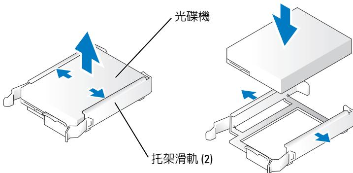
3 輕輕將磁碟機滑入到位，直至聽到卡嗒聲或感覺磁碟機已安裝穩固。
