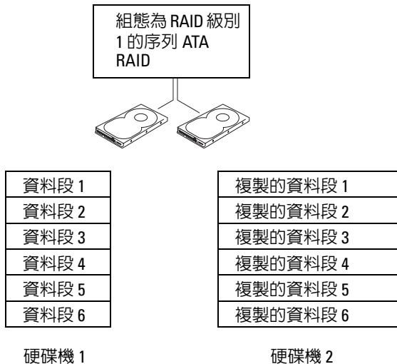
如果一個磁碟機出現故障，系統會將後續讀取和寫入作業引導至仍正常運作的磁碟機。可以使用仍正常運作的磁碟機上的資料重新建立一個替換磁碟機。此外，由於在兩個磁碟機上均複製了資料，兩個 120 GB RAID 級別 1 的磁碟機一起最多可以提供 120 GB 的空間儲存資料。
