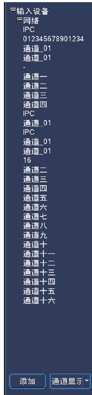
选择通道显示，设备树显示如图 4-4 所示，此时不显示设备节点，只显示所有的通道。
