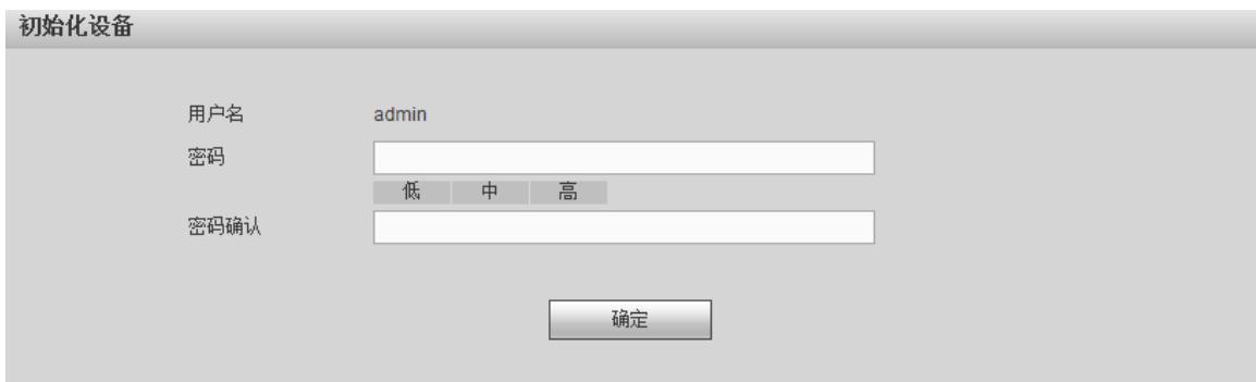
步骤2 输入密码并确认密码后，单击“确定”。
