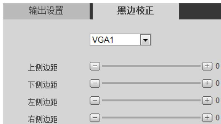
选择输出接口，根据实际情况对解码输出界面的屏幕边距进行调节。
