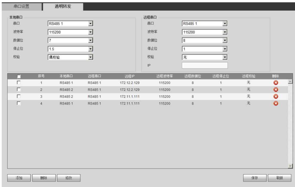
步骤2 通过设置“本地串口”和“远程串口”的参数，可控制模拟球机。
