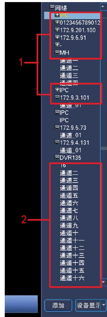
选择设备显示，设备树显示如图 4-3 所示，此时会显示设备（图中对应【1】部分），设备下的通道（图中对应【2】部分）。
