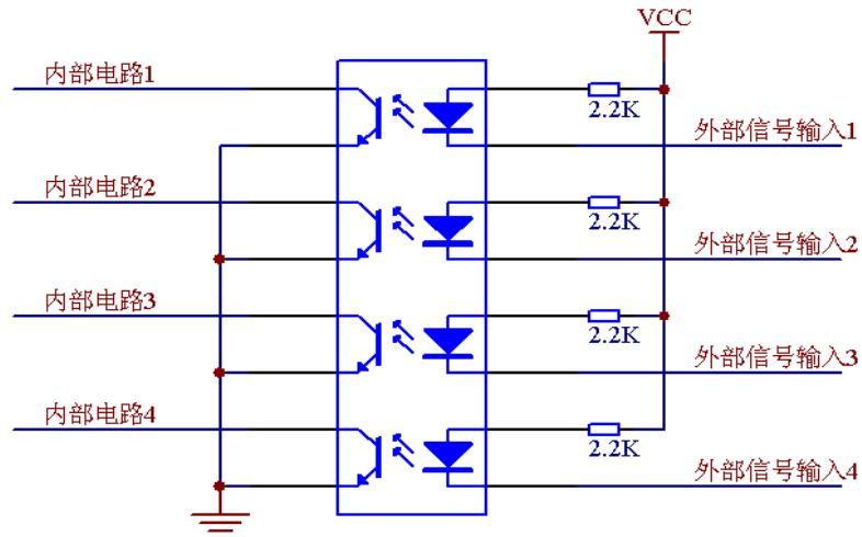
图5-7 报警输出端口模块示意图
