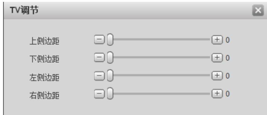
“上侧边距”、“下侧边距”、“左侧边距”、“右侧边距”：TV 上、下、左、右缩小的像素数，范围是 0~100。
