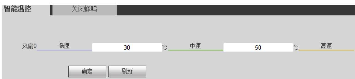
风扇转速分为三个级别：低速、中速和高速，不同的温度范围对应触发不同的转速级别。
