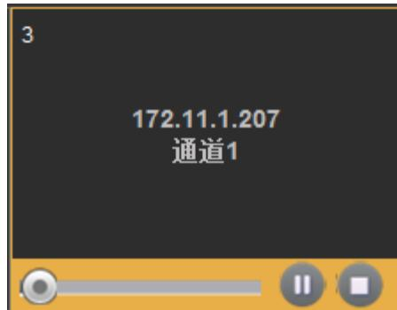
步骤6 双击该解码通道，可进行全屏播放。单击下方的回放控制按钮，可控制录像的播放、暂停和停止，调节进度条可控制录像的播放进度。
