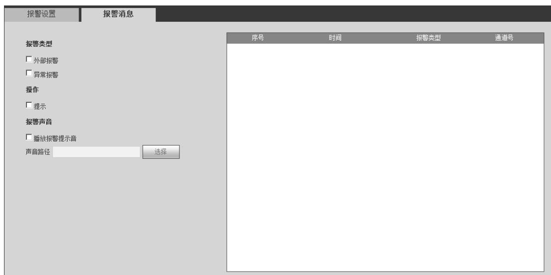
步骤2 针对外部报警和异常报警这两种不同的报警类型，设置报警提示方式等。
