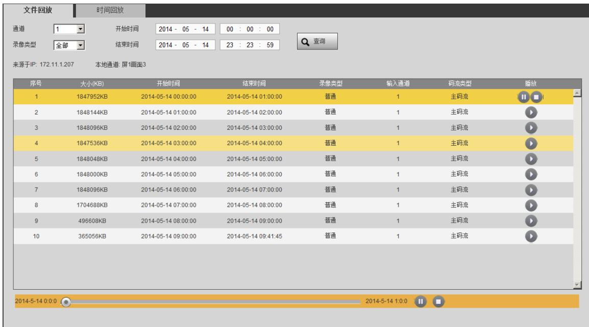
步骤4 单击下方的控制按钮，可控制录像的播放、暂停和停止，调节进度条可控制录像的播放进度。
