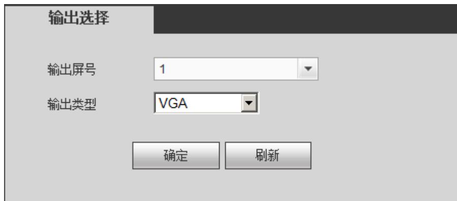
步骤2 选择“输出屏号”和与其对应的“输出类型”，输出类型包括 VGA 和 HDMI。
