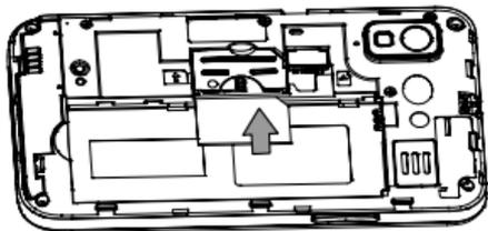
3. 按下图所示将 microSD 卡插入卡槽中。
