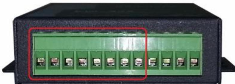
ZNX 202 支持 4 路 RS485 串口，其标识为 COM1\_D+/D-、COM2\_D+/D-、COM3\_D+/D-、COM4\_D+/D-，采用 5.08mm 间距的 12 位的插拔式接线端子引出用户串口信号。系统通过面板上的 COM1、COM2、COM3、COM4 指示灯显示串口 ttyS1~ ttyS4 的发送和接收状态。
