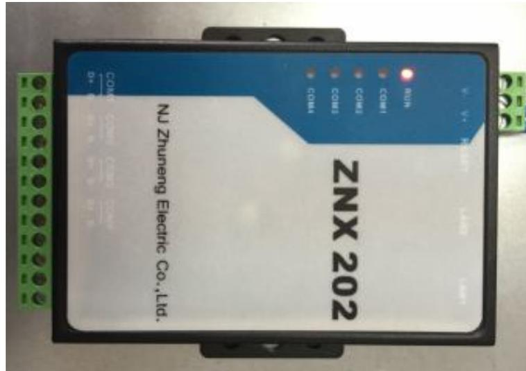
ZNX 202 是一款功能强大，接口丰富且功耗极低的壁挂式嵌入式通讯管理机。ZNX 202 是基于 RISC 架构工业级 ARM9 处理器，主频为 400MHz，内嵌 128MB DDR2 和 256MB Flash 存储器，支持 2 个 10/100M 自适应工业以太网接口、4 路 RS485 接口，内置实时时钟 RTC、蜂鸣器、温度传感器及硬件加密功能。非常适合于协议转换或数据采集等应用场合，支持 Linux3.6 操作系统，实现串口设备到以太网络的自动化信息采集和通讯协议转换等，是工业现场低成本解决方案的理想选择。
