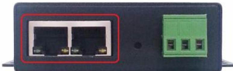
ZNX 202 支持 2 路 10/100Mbps 工业以太网接口，网络接口标识为 LAN1、LAN2，采用标准的带灯的 RJ45 网络接口，可以直接与普通网络连接。为了显示网络状态，系统用黄色灯显示网络 LINK 状态，绿色灯显示网络 FDX 状态。
