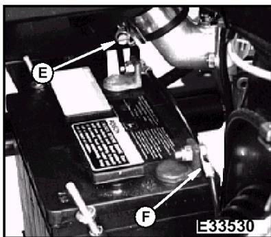
10. 将黑色负极 (-) 电线 (F) 连接到电瓶上。把凡士林油或硅树脂涂到接线柱上以防止腐蚀。确保接头已拧紧。
