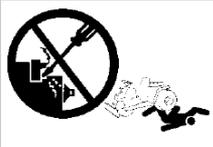
不允许短接启动马达接线柱来启动发动机。如果正常电路被旁通，机器可能挂档启动。
