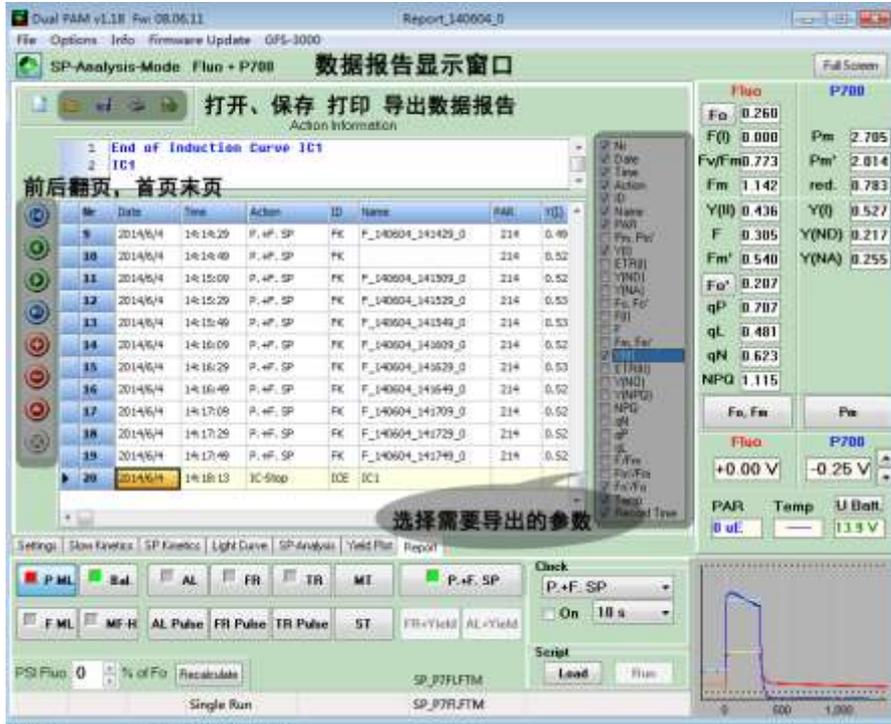
诱导曲线和光曲线的数据都显示在 **Report** 界面，主显示区最左边的一列按钮可以实现数据的翻页，中间为数据显示，最右面是数据的勾选框，即勾选上的才会在中间显示，不勾选的不显示。在主显示区的最上面是打开，保存，打印，导出数据的按钮，其中**软盘**保存的文件时可以用 **Dual PAM** 软件打开的，而“文件夹导出”的则为 **Excel** 格式的文件。
