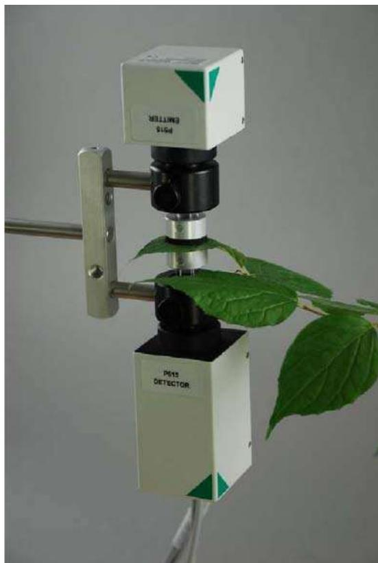
图 1 激发单元 DUAL-EP515和检测单元 DUAL-DP515
