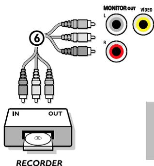
**MON. OUT** 连接器可用于连接或是从您的电视录制节目。当录像机连接到显示器输出端子时，可从您的电视录制某一模拟节目。请参阅第 13 页的使用录影机录制节目。
