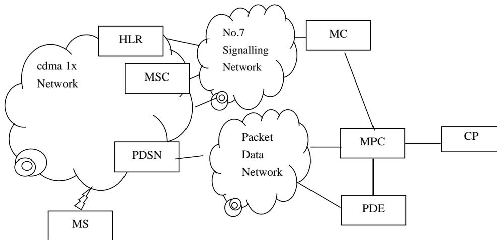
图 12-1 带 gpsOne 功能的网络结构图
