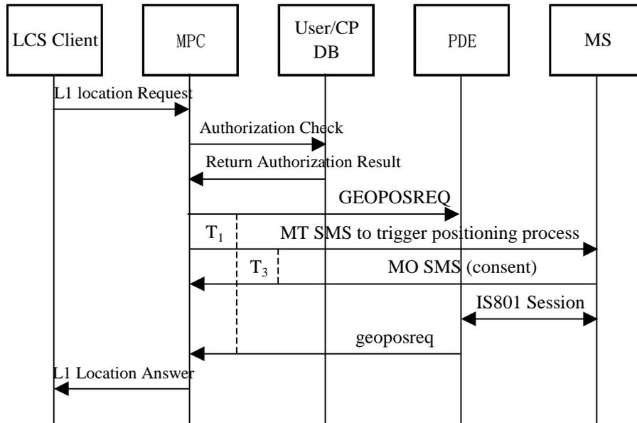
图 12-3 LCS Client 发起的 gpsOne 定位过程示意图
