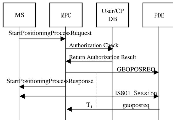
图 12-2 MO 发起的 gpsOne 定位过程示意图
