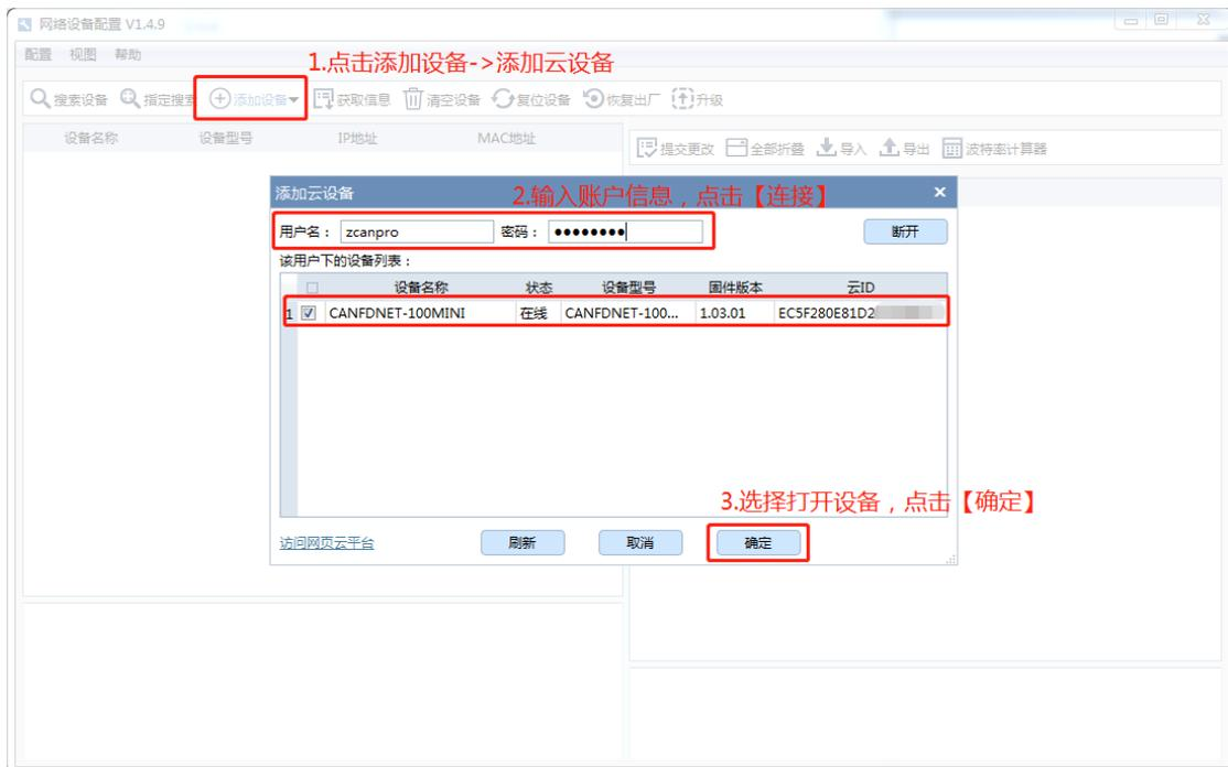
图 6.9 打开云设备操作示意图
