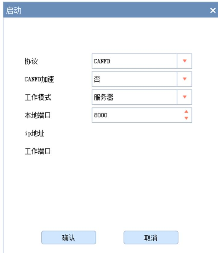
图 5.10 启动 CANFDNET-TCP 服务器界面
