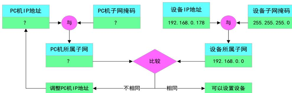
图 5.5 同网段检测流程
