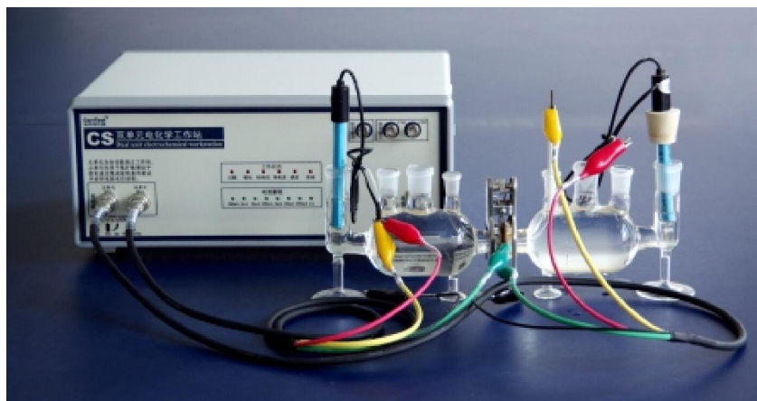
图2.金属中氢扩散控制
