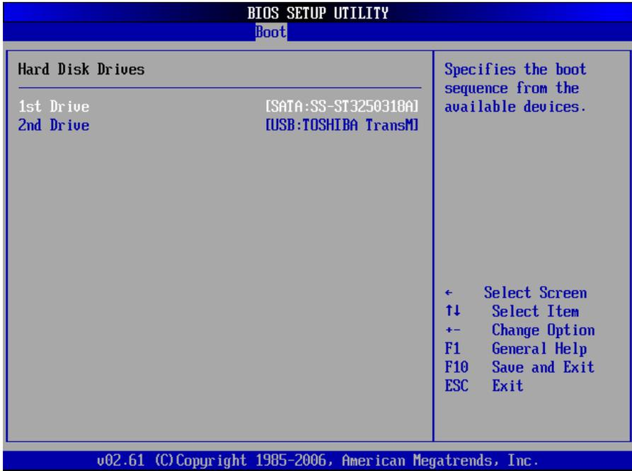
该项里包含有可以作为启动设备的硬盘，如果有多个硬盘，应在该项里选择这些硬盘的优先顺序，最优先的硬盘会显示在 Boot Device Priority 里。
