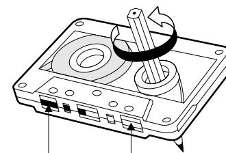
磁带（可录制部分） 引导带（不可录制部分）
