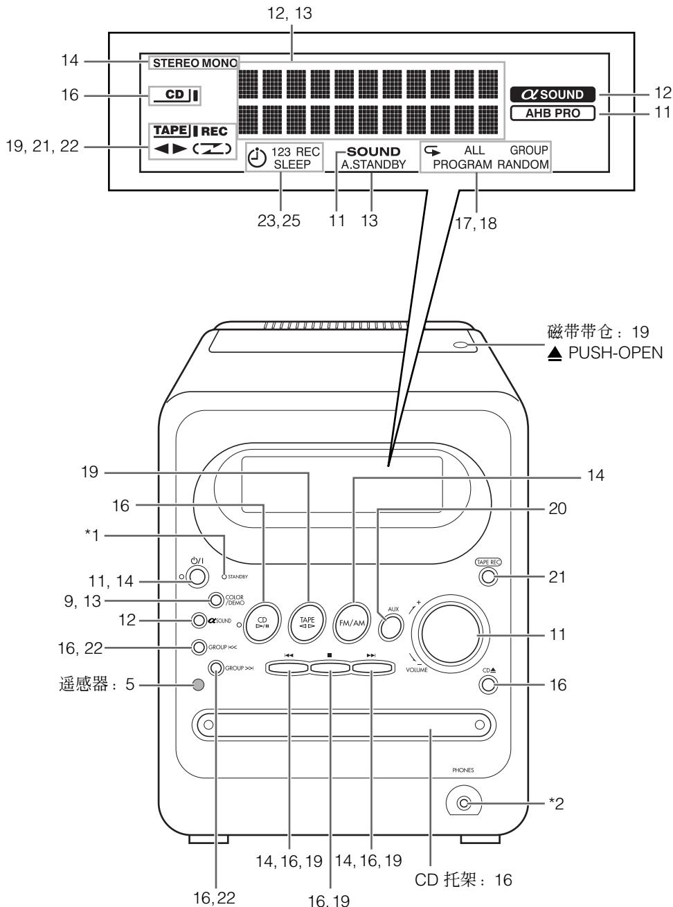
\*1 电源关闭时，STANDBY 指示灯呈红色点亮。电源打开时，STANDBY 指示灯呈绿色点亮。
