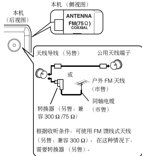
使用随机提供天线以外的天线时, 请参阅天线和转换器的操作说明书, 获取连接的详情。
