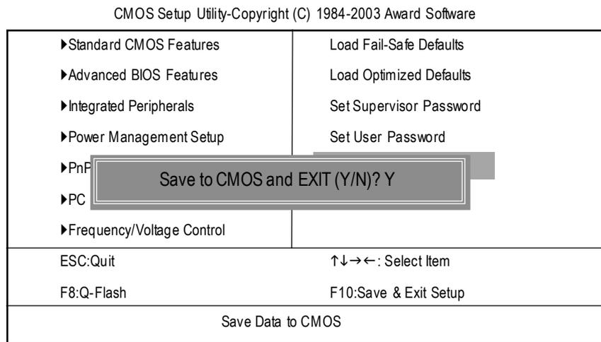
圖 12: 離開 SETUP 並儲存設定結果
