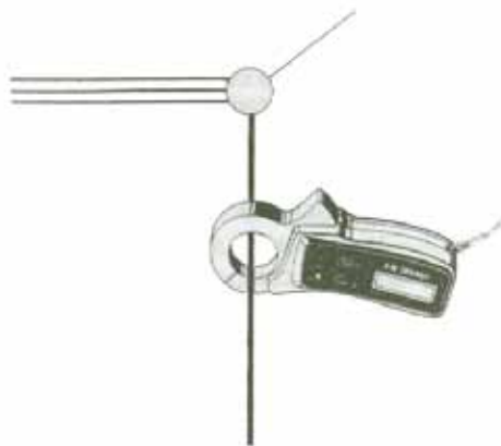
图 4-3 接地线的泄漏电流测量
