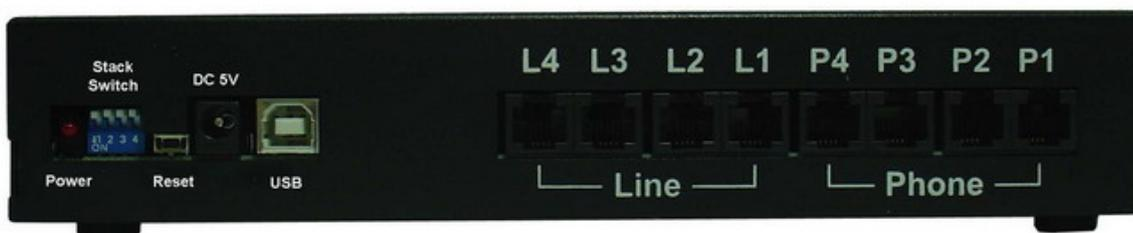
1. 將 5 伏/3 安培直流電源變壓器連接至 5V DC 插座。電源指示燈恆亮。
