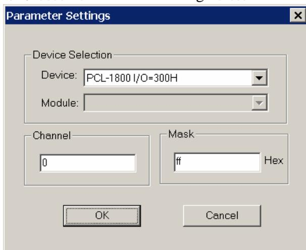
参数含义：Device 选择计算机中安装的板卡；
