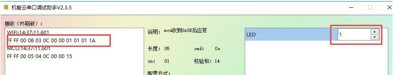
注意:MCU 串口工具是用来模拟 MCU 单片机的功能，在开发过程中，可以用工具用来模拟数据,体验数据交换过程。
