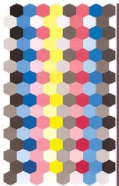
2. 根据纸张类型让测试图表晾干一段时间。在扫描时墨水应是干燥的，因为湿润墨水与干燥墨水的颜色稍有差别。
