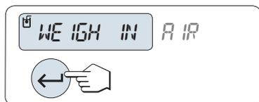
天平提示您在空气中称量液体密度测量块“WEIGH IN AIR”。
