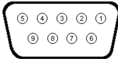
图 B-3 MODBUS 通讯接口
