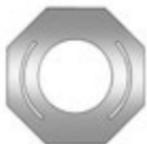
制动总泵储液罐中的DOT 4制动液经上汽通用汽车有限公司认可，储液罐盖上已注明“DOT 4”字样。关于储液罐的位置，请参见“发动机舱概览”。
