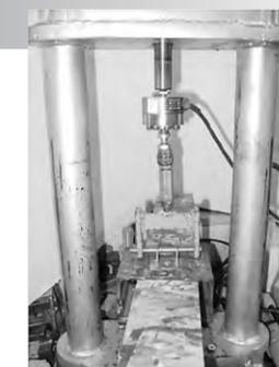
▲IC野地板用ビス引抜強度試験
