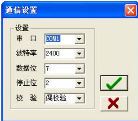
可以对串口、波特率、数据位、停止位和校验位进行设置。
