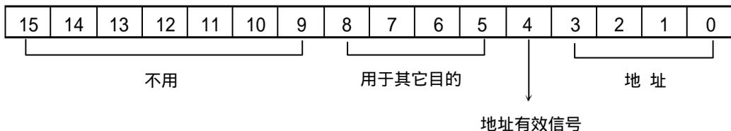
功能：假设D0输出4位作为地址，通过外部逻辑，可以通过宏DI 口得到与此地址相对的带有符号的3位BCD数值，输出的地址及输入的数据信号仅在其有效信号=1时方有效，输出时，不用的位可送零，用于其他目的的位不能改变其值，以下例子为送地址7时，读回相应的数据。
