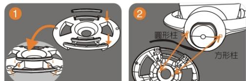
※一定要確實將本體與底座確實旋緊，以免風扇運轉時，發生搖晃現象。
