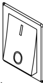
图 5-11 控制柜电源开关
