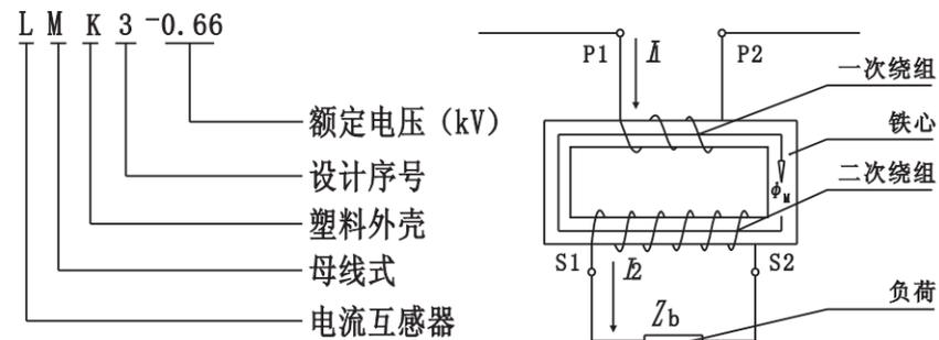
(图1) 电流互感器工作原理图
