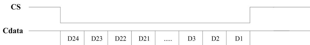
注意：片选信号 CS 拉低后, Cdata 再发送 24 位数据，先发送高位再发低位；使用低高电平比例来表示每位数据的数值。
