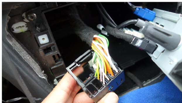
**雪铁龙 C4L**的拆卸次序类似：首先拆卸显示屏上的出风口，之后取下显示屏两边的塑料片，就可以很容易将显示屏和CD拆下来了。只要将LVDS电缆和CAN输入电缆分别串联在显示屏后和CD后，就完成了接口合的安装过程。
