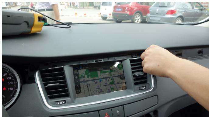
将整个出风口取下后，可以看到显示屏旁边的固定螺钉，拆卸这些螺钉，就可以取出显示屏，将接口合的视频电缆串联在显示屏后。如图表示。
