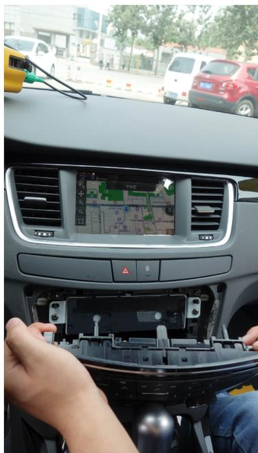
将CD的前塑料盖板取出，就可以看到固定CD的螺钉，之后就可以将整个CD抽取出来。
