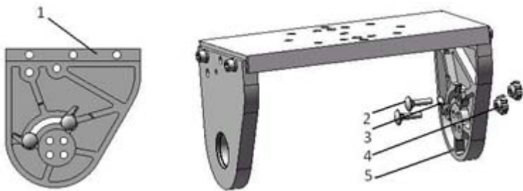
图 18 设置顶装云台垂直限位
